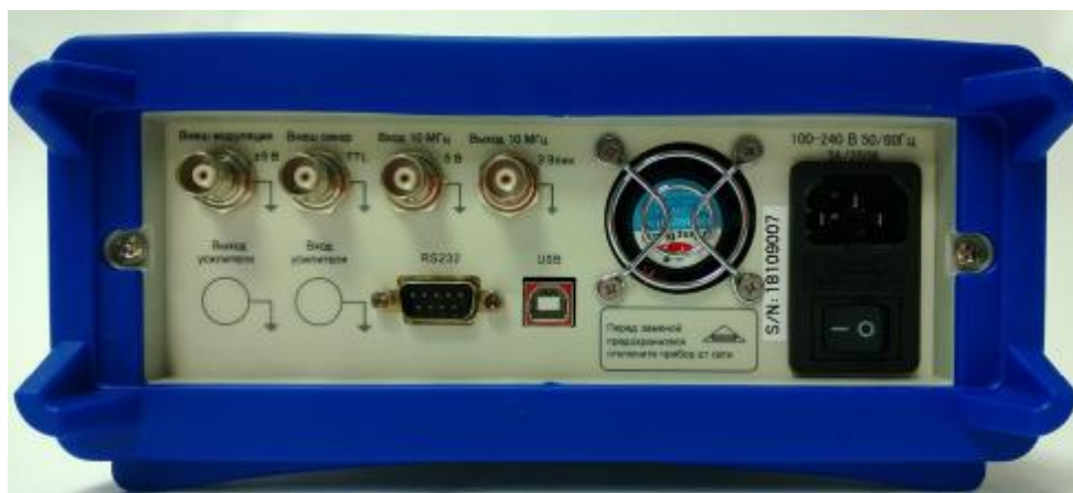
Рисунок 3 – Вид задней панели генератора АК ИП-3407
